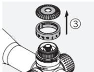
Scoateți inelul cu striții și inelul cu scara gradată.
