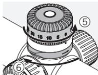
Теперь можно выбирать на турели желаемые настройки. Поверните механизм блокировки на четверть оборота по часовой стрелке, чтобы зафиксировать его.
