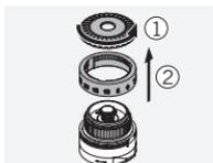
Deșurubați inelul cu striții de pe turelă. Scoateți inelul cu striții și inelul cu scara gradată (sau inelele de marcare).
