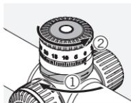
Проверьте нулевую настройку на турели и зафиксируйте механизм блокировки. Открутите от турели рифленое кольцо.
