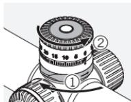
Verificați poziția zero a turelei și blocați mecanismul de blocare. Deșurubați inelul cu striții de pe turelă.
