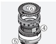
Montați inelul dreapta/stânga cu scara gradată. Asigurați-vă că poziția zero este aliniată cu punctul de referință. Închideți mecanismul de blocare. Reînșurubați inelul cu striții pe turelă.
