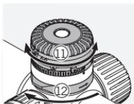
Теперь вы можете выбрать желаемые настройки. Поверните механизм блокировки на четверть оборота по часовой стрелке, чтобы зафиксировать его.
