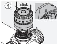
Montați turela pe lunetă până auziți un clic. Notați poziția zero în timp ce faceți acest lucru.
