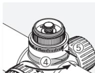
Deschideți mecanismul de blocare al turelei. Setăți marcajul turelei pe zero dacă acesta își schimbase poziția.
