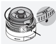
Поверните турель на 35 щелчков против часовой стрелки и выровняйте маркировку  $>|<$  в верхней части шкалы с индексной меткой. Затем закройте механизм блокировки.
