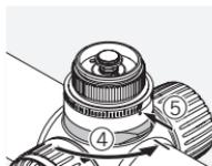
Откройте механизм блокировки на турели. Верните маркировку на турели к нулю, если она сместилась на другую позицию.
