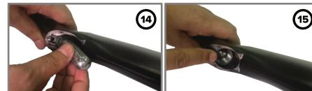
Закрутите шестигранным ключом поджимной винт по часовой стрелке. При проколе баллона иглой резким движением докрутите поджимной винт до прекращения стравливания газа (рис. 16,17).
