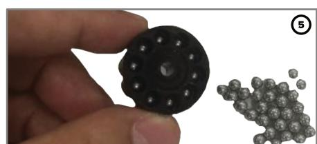
Вставьте барабан в магазин, сдвиньте ось-фиксатор в крайнее переднее положение (рис. 6,7).
